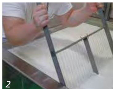
2 固まったミルク(カード)は、ワイヤーカッターで細かく切っています。
