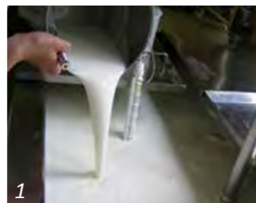
1 前日夕方に搾乳したミルクと、当日朝に搾乳したミルクを合わせ、低温殺菌。その後、乳酸菌などチーズづくりに協力してくれる微生物（スターター）を入れます。
