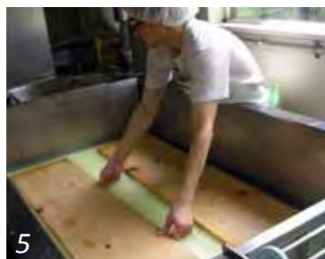
5 カードを中央に集め、布をかぶせ、鉄板と木の板を敷いてその上に重石をして均等に圧をかけます。
