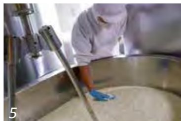
5 かき混ぜて、カードから水分(ホエイ)を分離させます。「ここで乳脂肪分をいかにとどめるか」がポイント。
